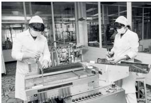
Електронна машина за преглед качеството на ампулите ЦДА, Албум 6 Д
