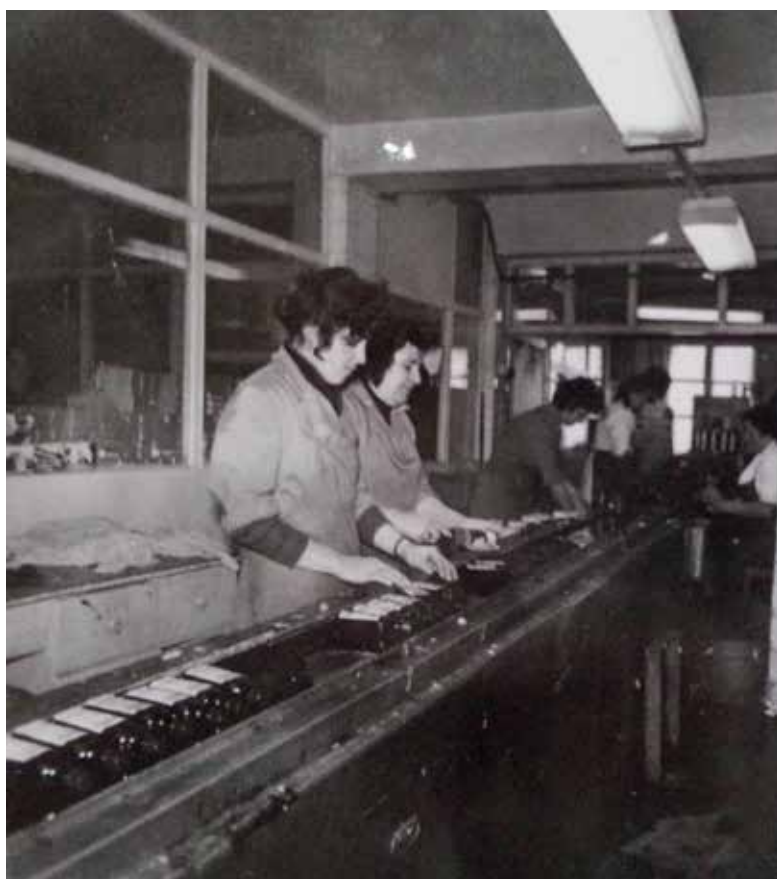
Автоматична поточна линия за пълнене на туби в цех „Галеника“. ЦДА, Албум 6 Д
