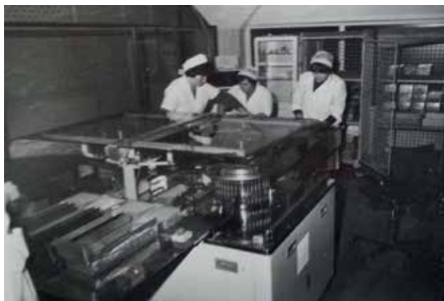
Електронна машина за преглед качеството на ампулите ЦДА, Албум 6 Д
