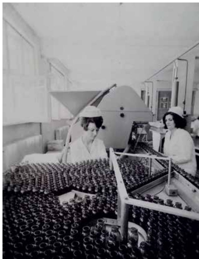
Поточна линия за автоматично опаковане на таблетки в стъклени флакони ЦДА, Албум 6 Д
