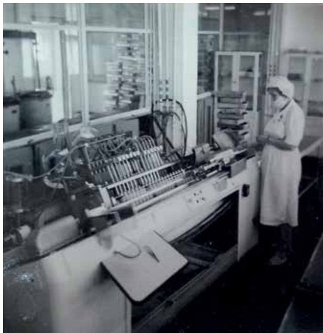
Автомат за дозирано пълнене и запойка на ампули
