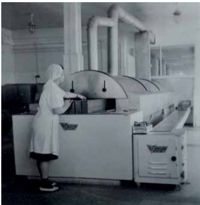
Електрически тунел за изсушаване на измитите ампули
