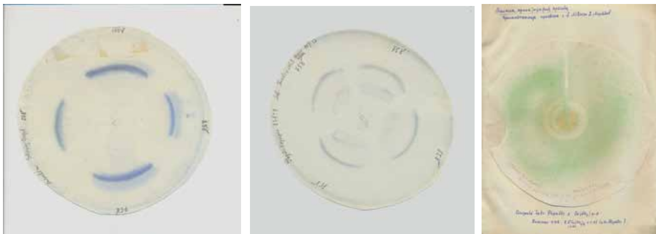
Образци на метода за хроматографско определяне на Инсулин и за изследване на Хепатис чрез хартиена хроматография, приложен от д-р Виктория Събева, научен сътрудник в Научноизследователския институт по фармация. София, 1957–1958 Семеен архив – Любка Шишкова
