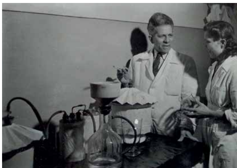
Рационализаторите маг.-фарм. Атанас Папаризов и технологът Стоянка Христова извършват манипулации по извличане на инсулин от остатъчни луги след изпадане на инсулина в изоелектричния апарат. ЦДА, Албум 6 Д; сп. Рационализация, 1960, кн. 1
