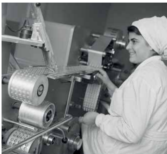
Нова машина за автоматично опаковане на таблетки в целофан Архив Пресфотото – БТА
