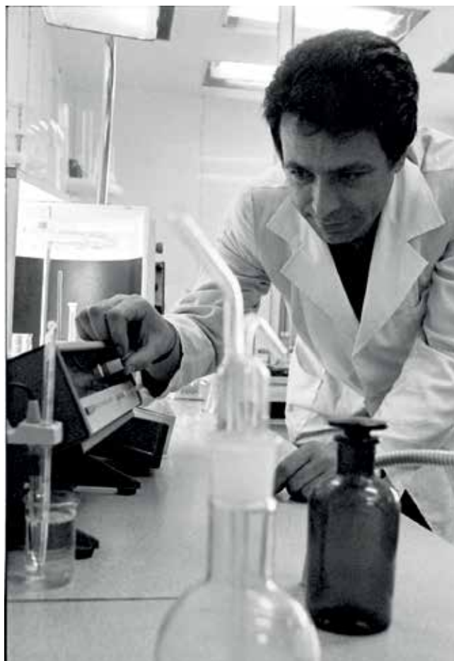
Технологът инж. Г. Димитров измерва РН на готов разтвор на Инсулин. Архив Пресфотото – БТА
