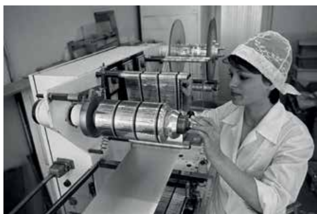
Опаковъчна машина – част от новите поточни линии за опаковка на таблетки Архив Пресфото – БТА
